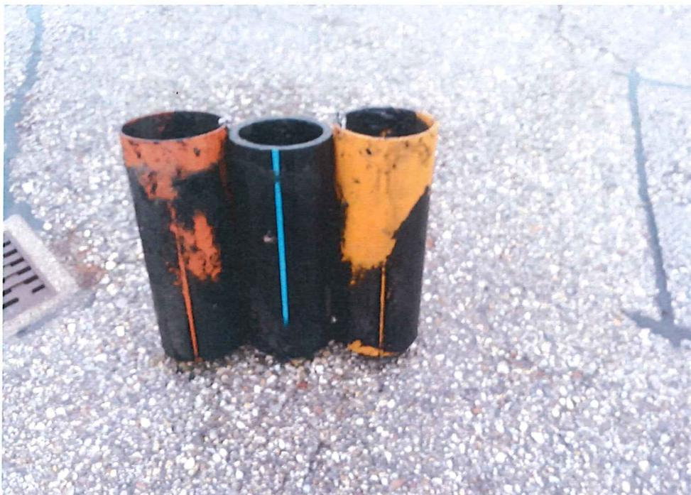
**Abb. 3:** Muster nach 12 Monaten Auslagerung in Kläranlage (Von links nach rechts: PVC, PE und PE)
