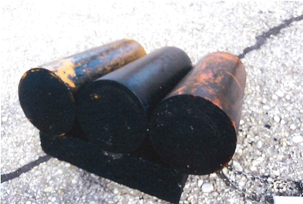
**Abb. 2:** Muster nach 3 Monaten Auslagerung in Kläranlage (Von links nach rechts: PP, PE und PVC)
