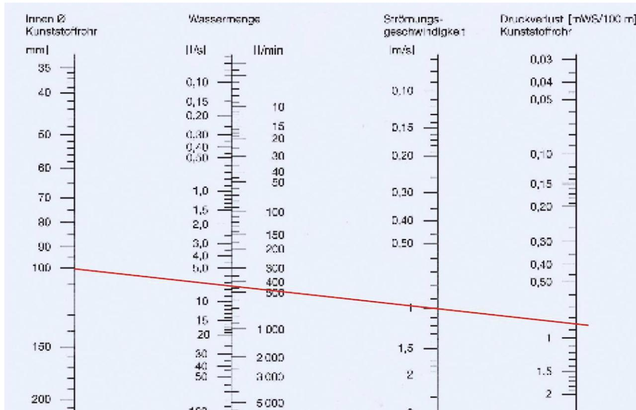
**Beispiel rote Linie:** Bei einem Rohr-Innendurchmesser von 100 mm und einem Durchfluss von 7,5 l/s ergibt sich eine Strömungsgeschwindigkeit von 1 m/s und ein Druckverlust von ca. 0,85 mWS/100 m, was einem Druckverlust von 0,085 bar/100 m entspricht.
